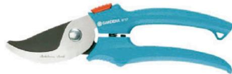
Cabeza de corte muy estrecha e inclinada especial para cortar la vid y los sarmientos. Cuchilla superior con revestimiento antiadherente, cuchilla inferior en acero inoxidable. A lado de precisión. Empuñadura ergonómica con 2 posiciones de corte: rápido o potente. Cierre centralizado de seguridad. 25 años de garantía.
