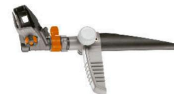
Aspersor silencioso para grandes superficies. Alcance de riego desde 5 m hasta máx. 12 m. Anillos de ajuste para facilitar la definición precisa del sector de riego de 20° - 360°. Turbina patentada resistente a la suciedad. Con filtro de malla móvil. Posibilidad de montar varios aspersores en serie con macho para grifo. ref. 901.
