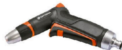
Pistola de metal con componentes de plástico duro y blando, a la vez robusta y ligera. Ajuste progresivo del tipo de chorro: desde concentrado hasta brumizado. Chorro regulable en continuo. Gatillo de bloqueo delantero ergonómico para bloquearlo, con un solo dedo. Cabeza de riego robusta e inseparable del cuerpo. Tarjeta informativa a todo color.
