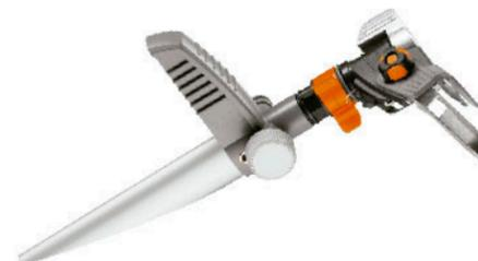
Anillos de ajuste para facilitar la definición precisa del sector de riego de 25° - 360°. Botón de ajuste grande con componentes de plástico blando, para un ajuste en continuo del alcance de riego desde 5 - 12,5 m. Superficie de riego de 75 hasta 490 m<sup>2</sup>.
