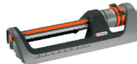
Aspersor oscilante compacto con una combinación metal/plástico de alta calidad. Boquilla en plástico blando para asegurar un reparto uniforme del agua. Superficie de riego 28 m - máx. 350 m<sup>2</sup>. Alcance de riego: 7 m - máx. 21 m. Anchura de riego: 4 m - máx. 17 m.
